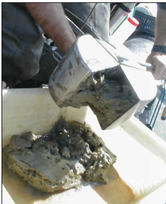
Figure 22 : Prélèvements du sédiment effectués avec une benne de type Van Veen (photo Vincent Bertrin, Cemagref).
