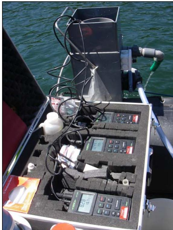
Figure 2 : Pompe et appareils de mesures physico-chimiques de terrain (photo Vincent Bertrin, Cemagref).
