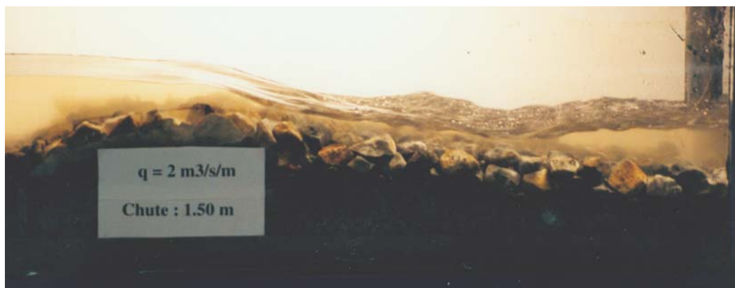
Figure 9 : Ecoulement sur une rampe en enrochements jointifs de pente 10% (modèle échelle 1/22)
