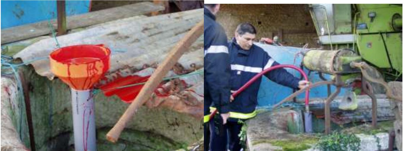
*Illustration 75 : Dispositif d'injection au puits de Chaunay de la sulforhodamine G et de l'eau pour l'effet de chasse*
