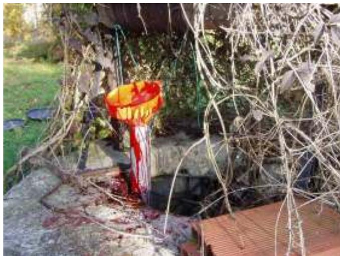
*Illustration 76 : Dispositif d'injection au puits de Brux de l'éosine*
