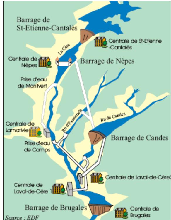
Figure 1 : Les différents aménagements hydroélectriques de la Cère (schéma tiré du contrat de rivière Cère, EPIDOR, septembre 2000)
