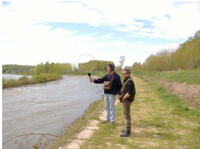
**Figure 20 : Antenne manuelle orientée dans la direction d'un poisson radiomarcué**
