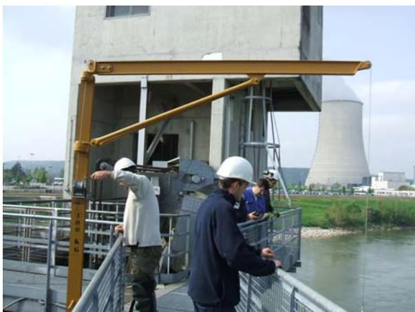
Figure 3 : Treuil assurant le transfert des poissons
