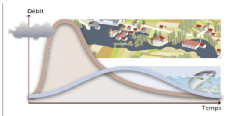
Figure 1. Schéma de principe des services « contrôle des crues » et « soutien des étiages ». Courbe brune : « sans » les tourbières. Courbe bleue : avec.
