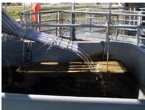
**Figure 16 : Vue de la plaque de détection des marques Pit Tag**
