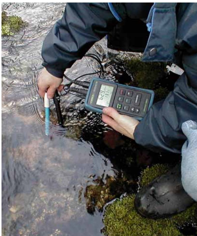
Mesure de la conductivité à l'exutoire d'une source karstique Photo GINGER
