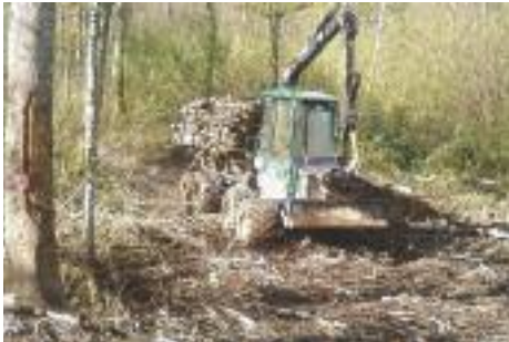
Circulation sur des rémanents
