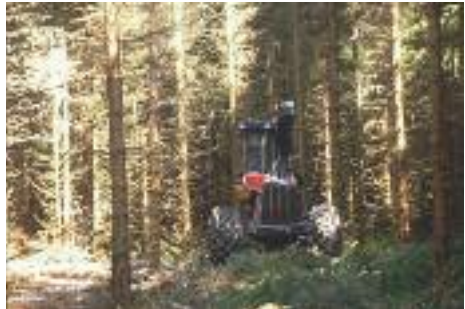
Circulation sur des rémanents
