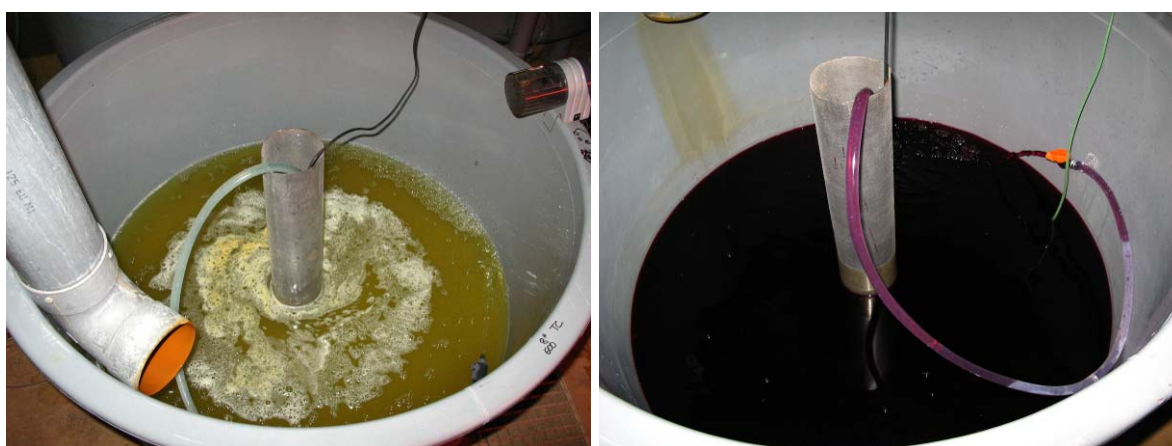
Figure 35 : Vue des bains de TC 600 ppm (g) et d'ARS 400 ppm (d)
