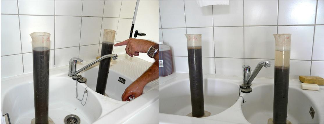
**Photo 12 et Photo 13 : expérience démontrant le rôle des coagulants**
