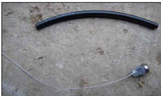
Photo 11 : Emetteur utilisé pour le marquage des smolts avec son tube pousseur
