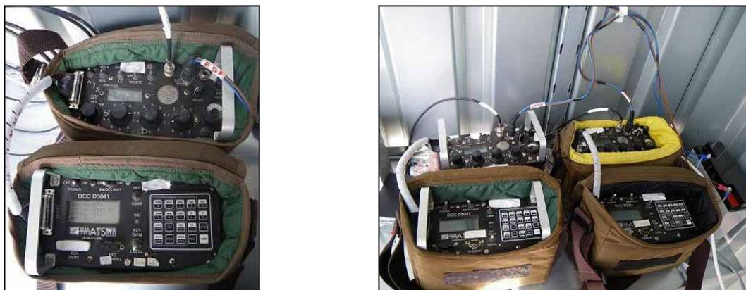
Photo 12 : Exemples de couples récepteur/enregistreur utilisés pour la détection des smolts
