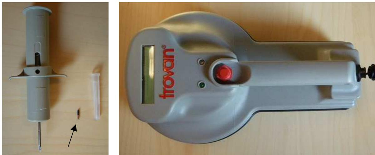
Photo 31 : Seringue de marquage, transpondeur RFID utilisé et son lecteur
