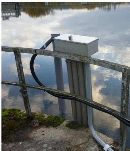
Photo 22 : Sondes de la station multi-paramètres DTG installée à Mauzac
