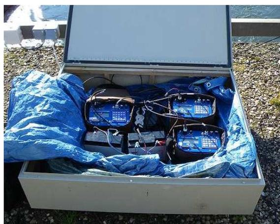
Photos 26 et 27 : Exemples d'installations de postes enregistreurs utilisés pour la détection des anguilles
