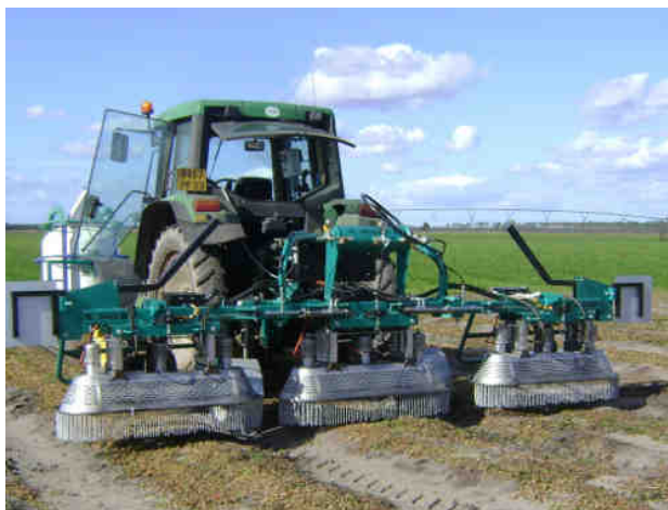
Machine conçue pour le désherbage des rangs de carottes dans la haute lande
