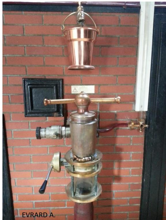
Photo 3 : Alcomètre servant au tri du distillat.
