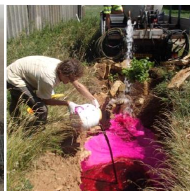
Injection de sulforhodamine B à St Etienne de Naucoules
