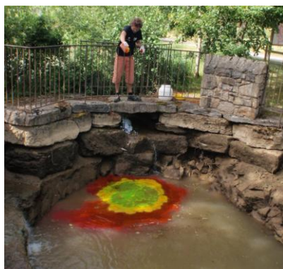
Injection d'uranine et de sulforhodamine B au trou du Souci
