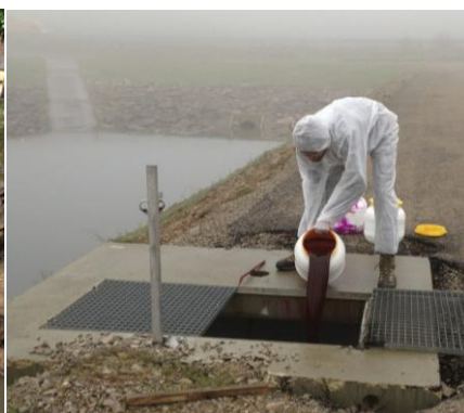
Injection de sulforhodamine B au bassin de l'A75
