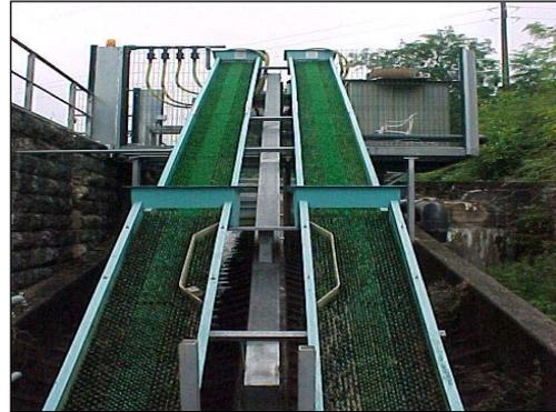
**Figures 12 et 13 : Partie aval et amont de la passe à anguilles**
