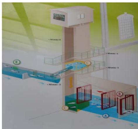
**Photo 2 : Vue et schéma de l'ascenseur à poissons de Tuilières (Source EDF)**
