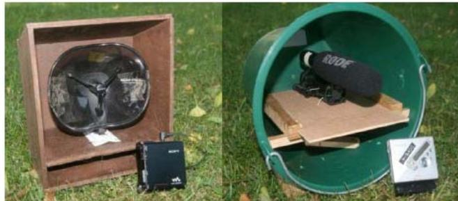
**Figure 10 : Dispositifs d'enregistrement audio numérique**
