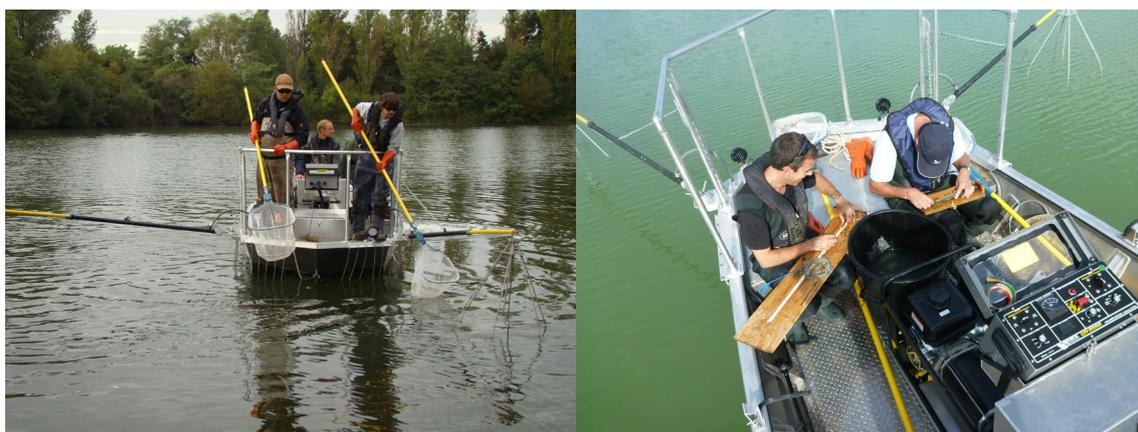
**Figure 2** : Photographies du bateau de pêche électrique en configuration d'échantillonnage. Les bras anodes situés à l'avant du bateau sont alors déployés.
