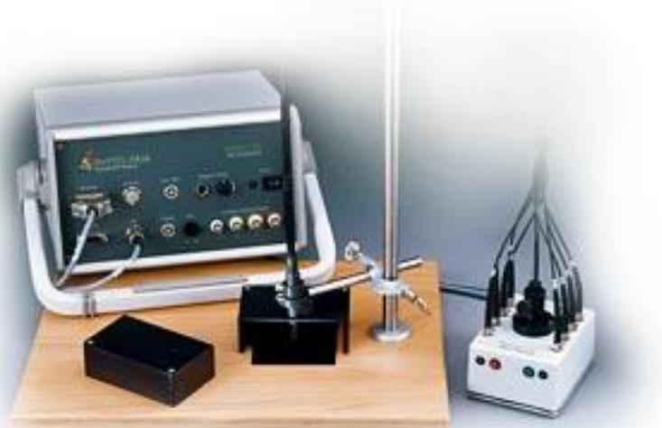
**Figure 2 : Dispositif PhytoPAM avec fibre optique et boîte noire (conditions DAS).**
