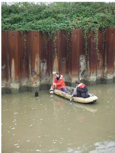
**Figure 16 : Réalisation de profils en travers et en long des jalles en amont des ouvrages.**
