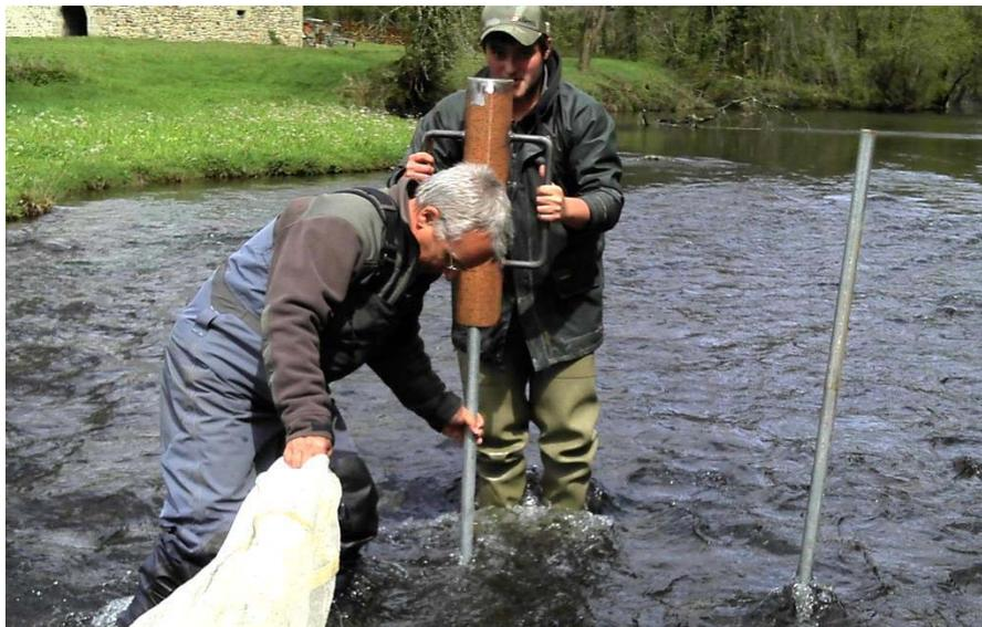
**Figure 4 : Photographie de l'installation des pieux d'amarrage amont du filet.**
