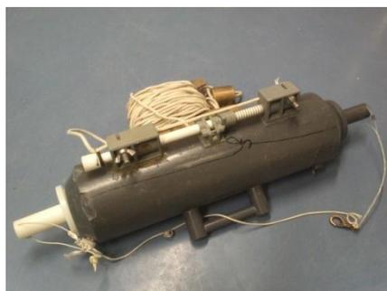
Photo 3 - Bouteille de prélèvement d'eau VAN DORN.
