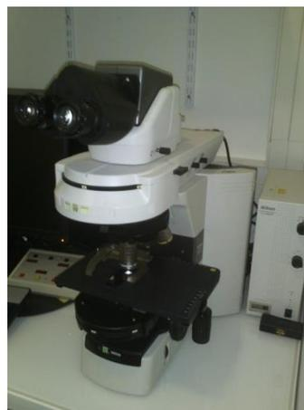
Photo 7 - Microscope droit à contraste interférentiel.
