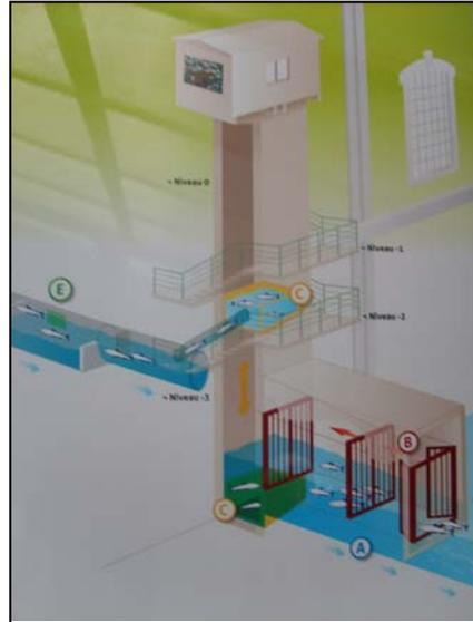
**Photo 2 : Vue et schéma de l'ascenseur à poissons de Tuilières (Source EDF)**
