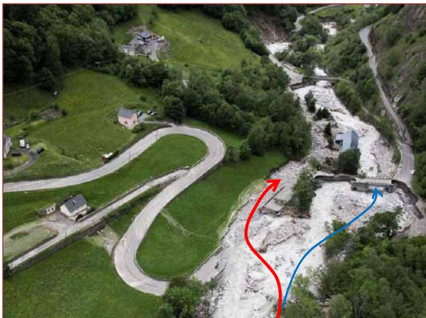
*Le Bastan au pont de Luz-Esquièze (65) – le verrou a favorisé l'inondation en rive gauche, la mobilité et la sédimentation des alluvions charriées, en amont - (source DDT65)*
