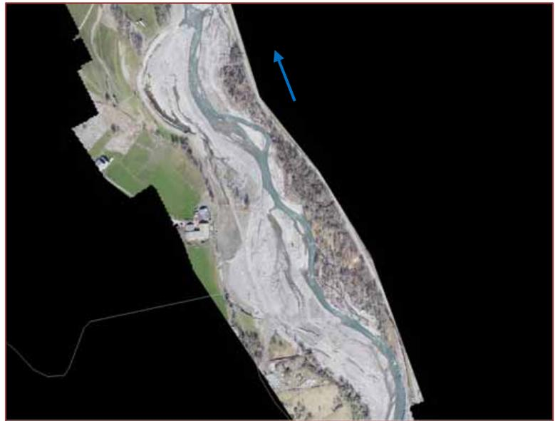
☞ Les **photographies aériennes nadirales brutes** ne permettent pas une saisie directe sous SIG, lors de la photo-interprétation. Elles nécessitent soit un calage (ortho-rectification + géo-référencement) préalable soit une analyse comparative avec un référentiel géographique (BD-ORTHO ou autre).
