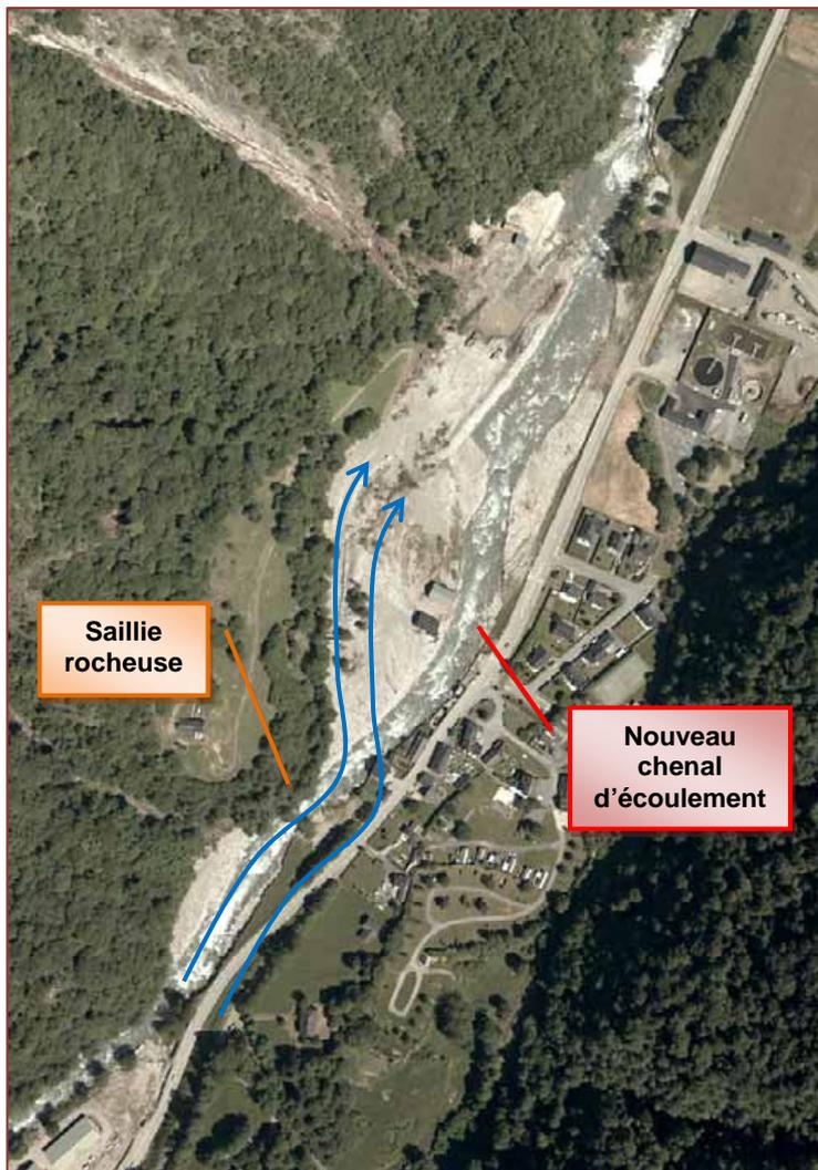
*Le gave de Cauterets, quartier Concé, avant (à gauche) et après la crue (source BD-Ortho 2010, IGN et analyse GéoDiag)*
