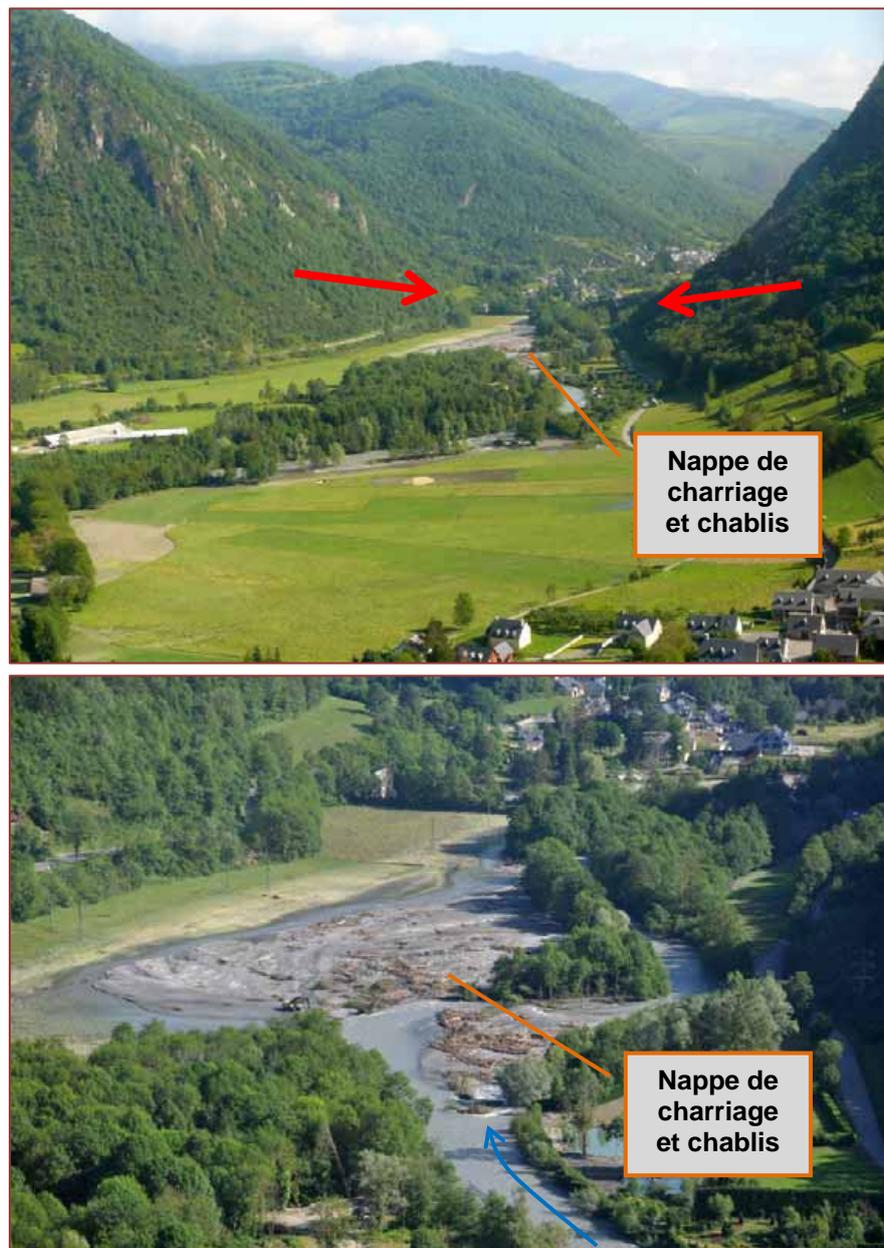
☞ Sur la **zone tampon située en amont du verrou**, la crue peut s'étaler, les débordements, la sédimentation des alluvions charriées et le dépôt des chablis sont favorisés. Cela réduit d'autant le volume (liquide + solide) à faire transiter au niveau du verrou ainsi que le risque de formation d'embâcle au droit de celui-ci ou des ouvrages transversaux qui y sont implantés.
