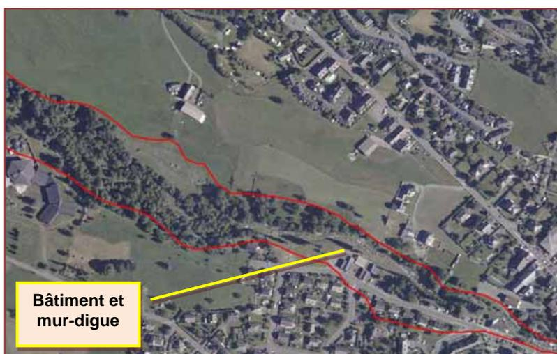
*Le cône du Bastan à Esquièze (65) – En rive droite, la bande active de juin 2013 s'étend très largement au-delà de celle de 1945, à partir du point dur (bâtiment + digue + protection de berge) implanté au sein de la bande active historique – source IGN/DDT65*
