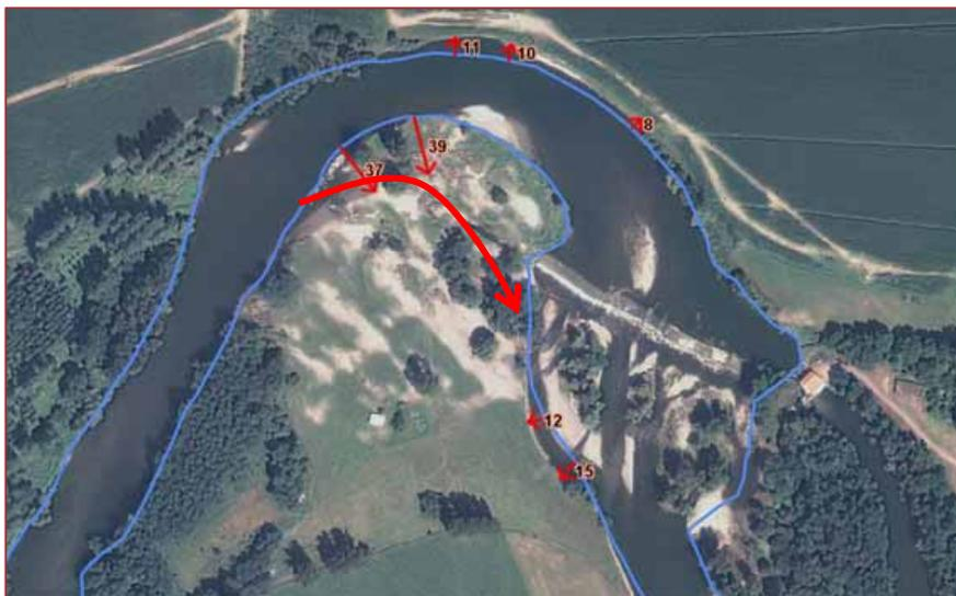
C'est notamment le cas sur la Garonne dite hydroélectrique, où les principales zones d'érosion latérale se situent en aval des barrages de Boussens et de la Brioulette. Elles y sont associées à un décapage marqué du substratum molassique et de l'ancien plancher alluvial, lorsqu'il était encore présent latéralement, sous la forme de terrasses.
