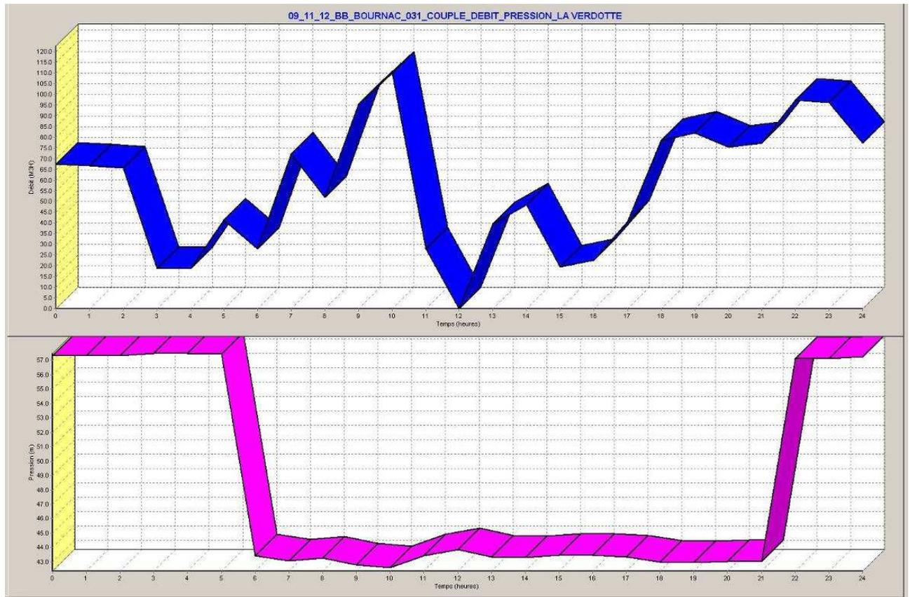
**Figure 44 : Evolution du débit et de la pression sur 24 h pour la station de la Verdotte dans la configuration projetée**
