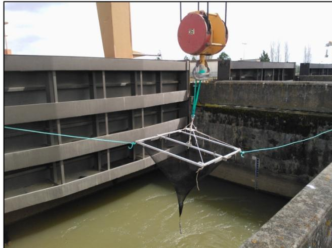
Figure 55 : Filet carrelet suspendu au palan du pont grue de la centrale au-dessus d'un puits
