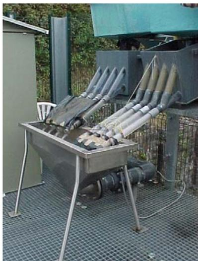
**Figure 14 : Tubes du compteur à anguilles**
