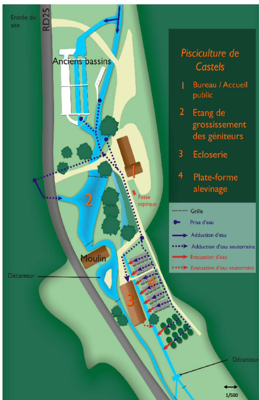
Figure 1 : Plan de la pisciculture de Castels, bâtiments et dispositif de production.
