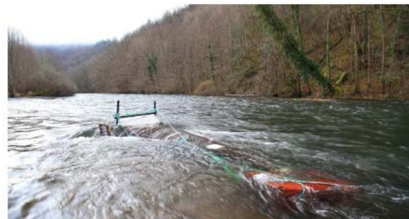
Photos 11 et 12 : Le piège est couché et n'est retenu que par le filet
