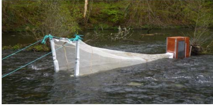
Photo 1 : Le dispositif de filtration permettant de récupérer les alevins de salmonidés (entre autres)
