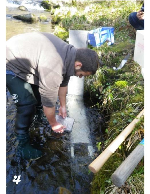
Photo 11 : Disposition d'un incubateur de terrain Firzloff.
