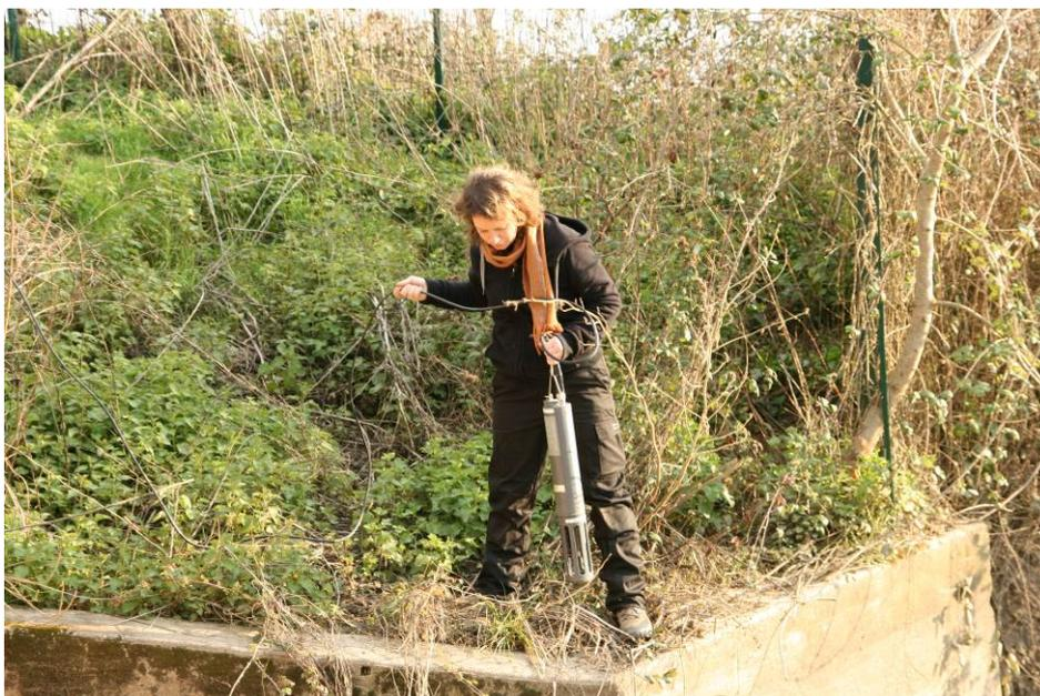
**Figure 40 : Mesures de la turbidité grâce à une sonde multi-paramètre.**
