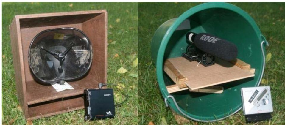
**Figure 31 : Dispositif d'enregistrement audio numérique avec micro parabolique et enregistreur SONY MZ-RH1 (à gauche) et micro directionnel avec enregistreur SONY MZ-N710.**
