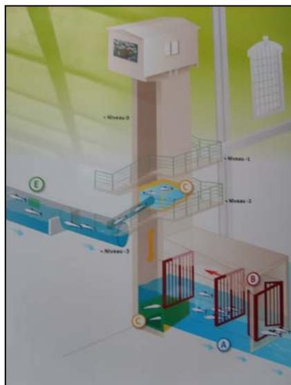
**Photo 2 : Vue et schéma de l'ascenseur à poissons de Tuilières (Source EDF)**
