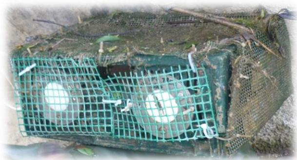
Figure 16. Cagettes prêtes à être posées sur le terrain. Les POCIS sont positionnés face au courant tandis que les DGTs (sur le côté de la cagette) sont placés dans le sens parallèle au courant.
