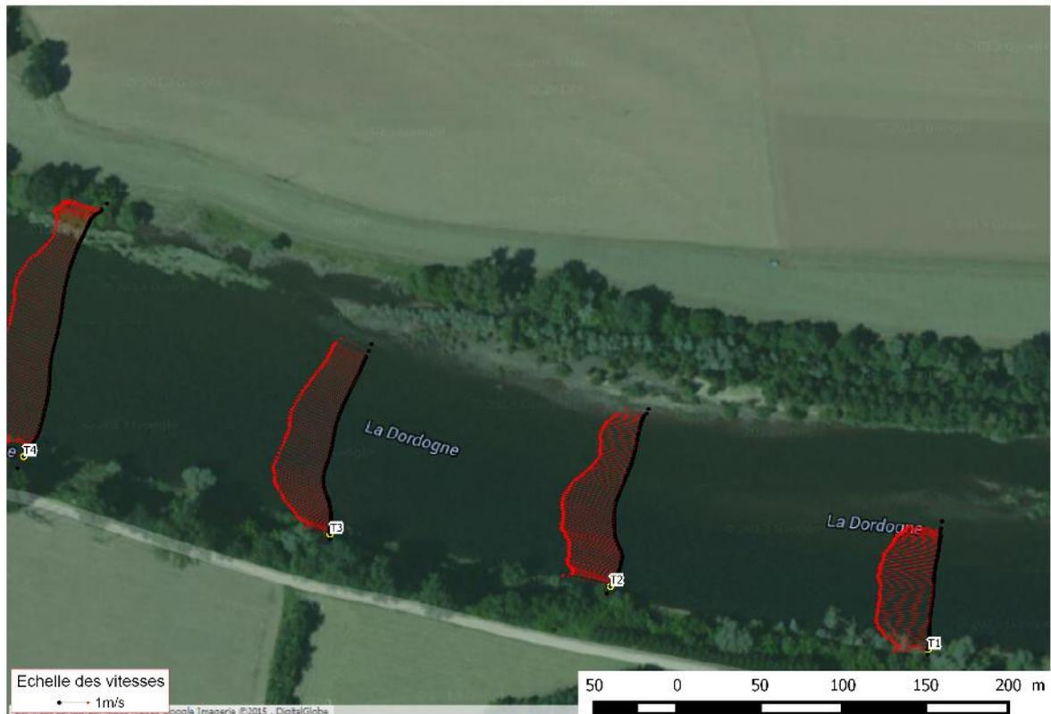
Figure 11-30 : Site de Montfort - Champ des vitesses sur les profils en travers T1 à T3
