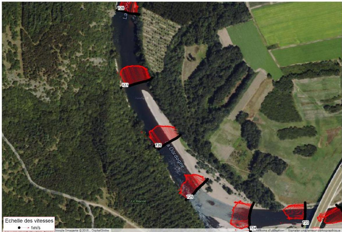
Figure 11-15 : Site de Pinsac - Champ des vitesses sur les profils en travers T23 à T28
