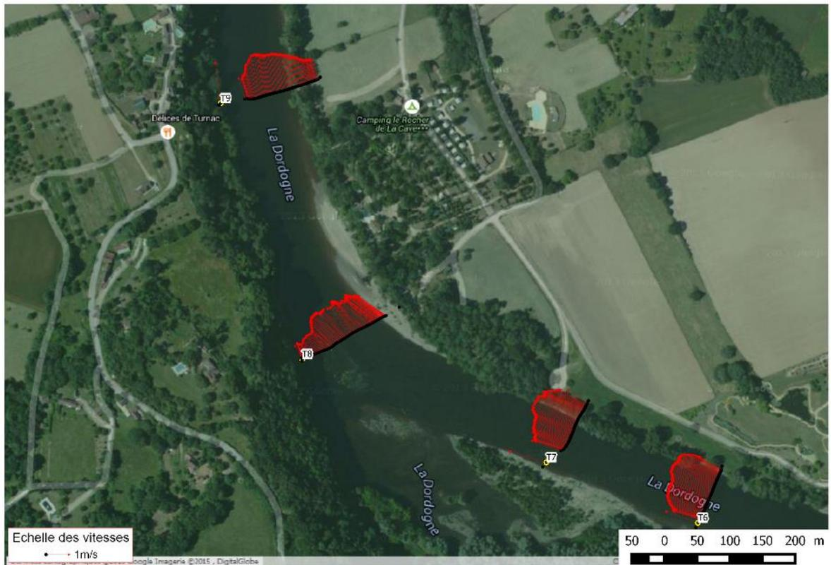
Figure 11-34 : Site de Montfort - Champ des vitesses sur les profils en travers T6 à T9
