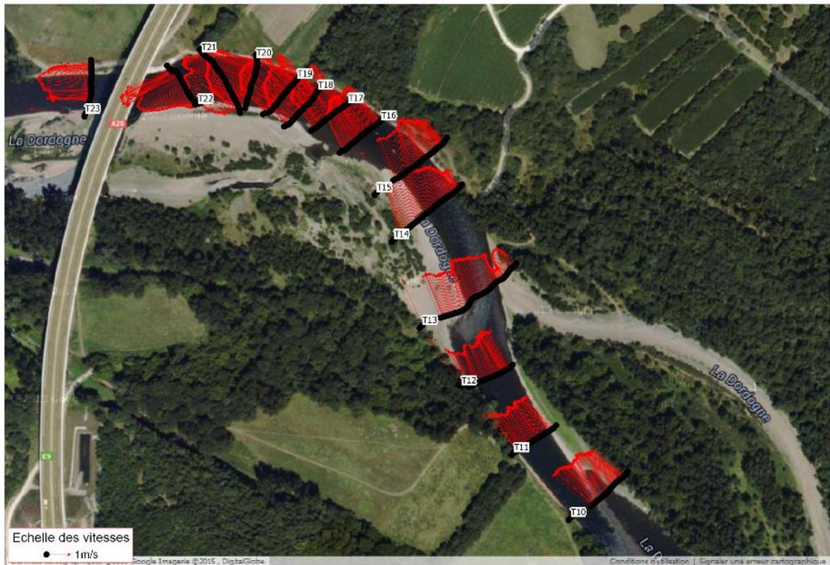
Figure 11-13 : Site de Pinsac - Champ des vitesses sur les profils en travers T10 à T23
