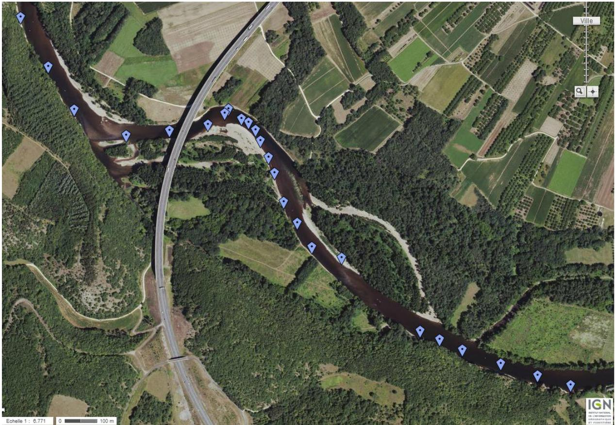
**Figure 11-3 : Site de Pinsac - Points GPS des profils en travers mesurés (Geoportail)**
