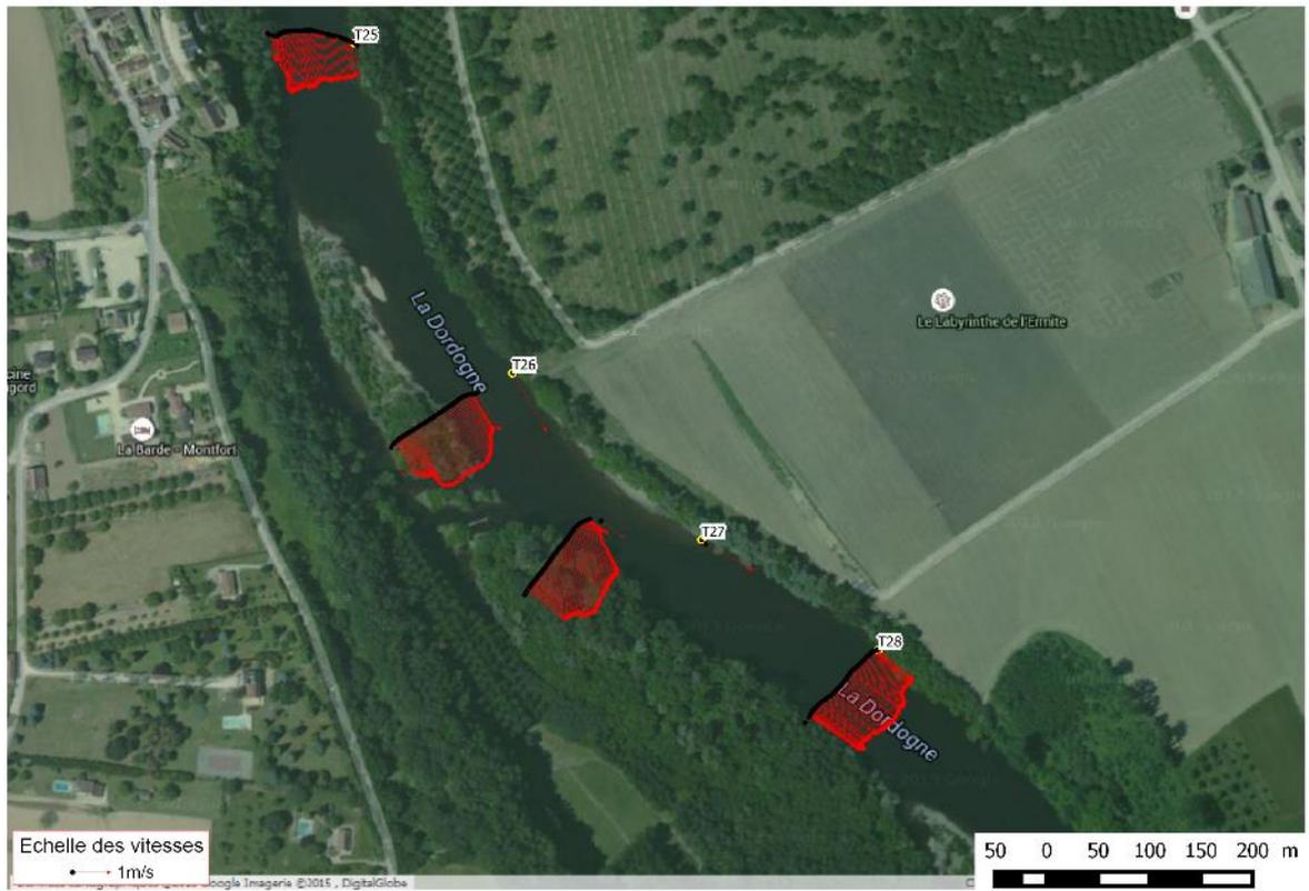
Figure 11-41 : Site de Montfort - Champ des vitesses sur les profils en travers T25 à T28
