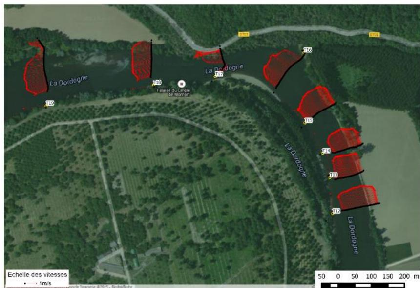
Figure 11-37 : Site de Montfort - Champ des vitesses sur les profils en travers T12 à T19
