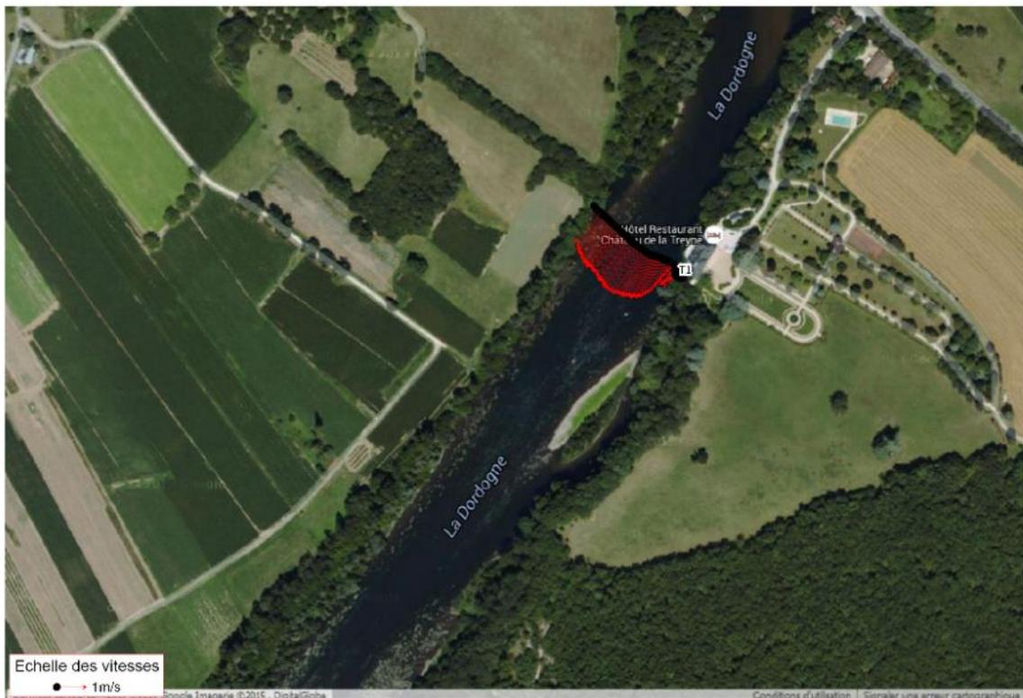
Figure 11-6 : Site de Pinsac - Champ des vitesses sur le profil en travers T1
