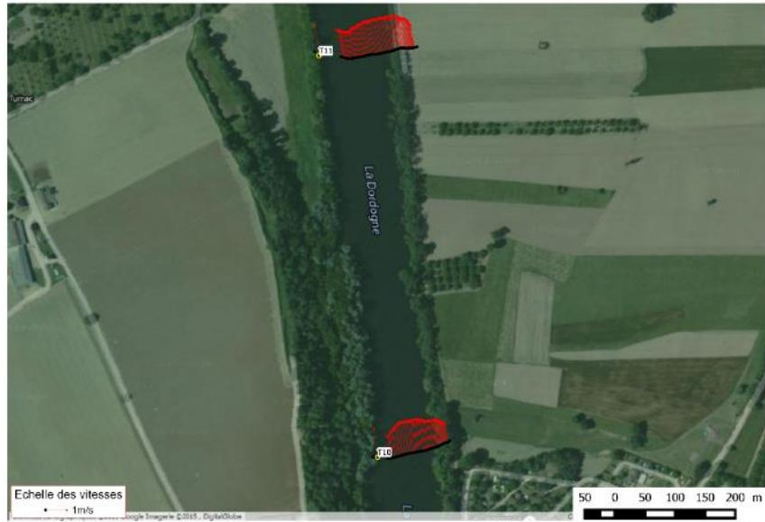
Figure 11-36 : Site de Montfort - Champ des vitesses sur les profils en travers T10 à T11
