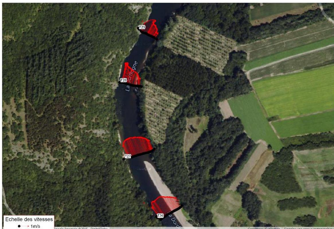
Figure 11-17 : Site de Pinsac - Champ des vitesses sur les profils en travers T26 à T29
