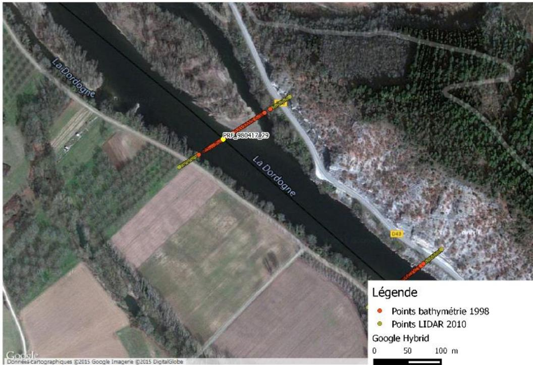
**Figure 10-9 : Limite du calage d'HEC-RAS - Profil RS89902 au niveau d'une annexe hydraulique**
