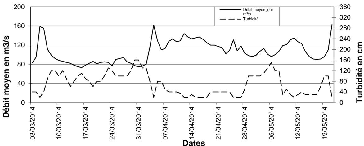
**Figure 3 : Evolution de la turbidité (en cm mesurée au disque de Secchi) et du débit moyen journalier (en  $\text{m}^3/\text{s}$ ) de la Garonne enregistrés à Gourdan-Polignan (EDF).**
