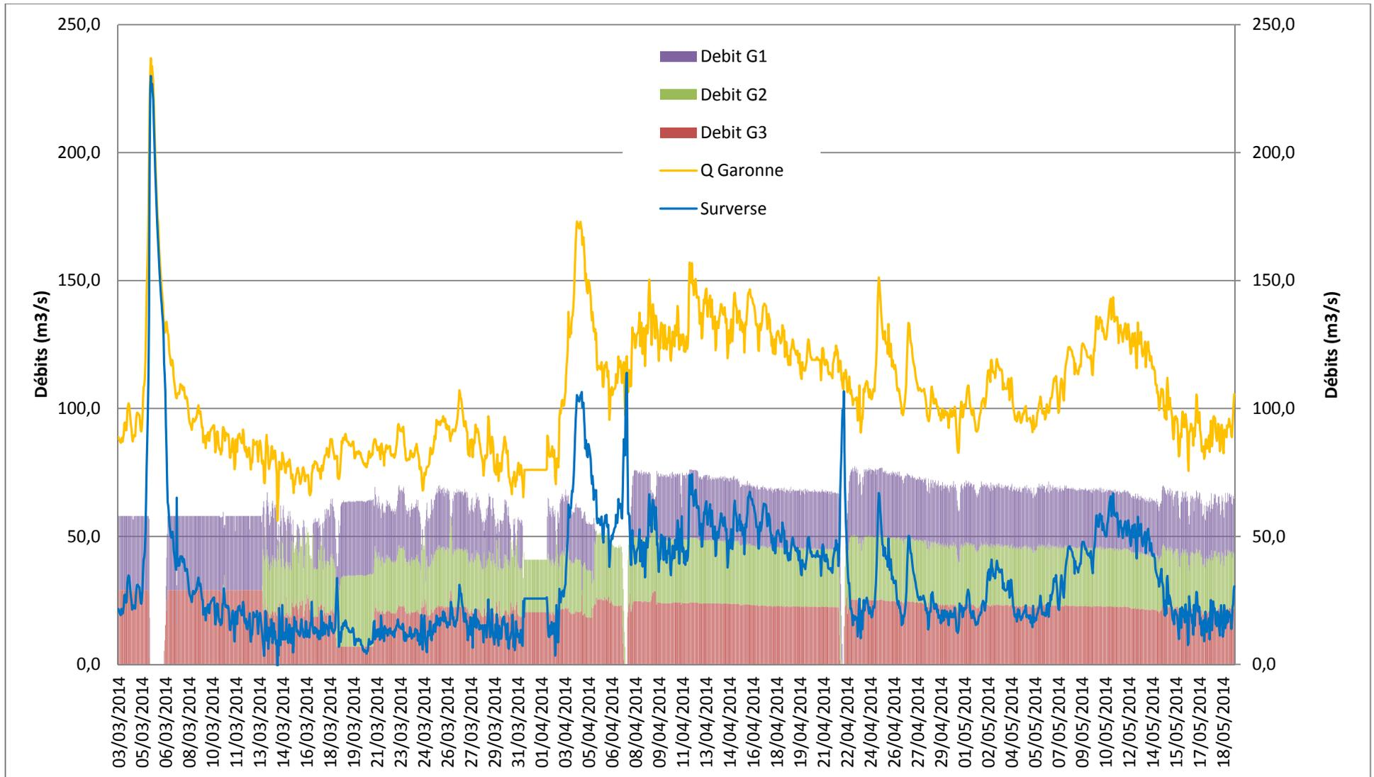
Figure 4 : Détails du fonctionnement des groupes de l'usine de Camon durant la campagne 2014 (débit exprimé en  $m^3 \cdot s^{-1}$ )
