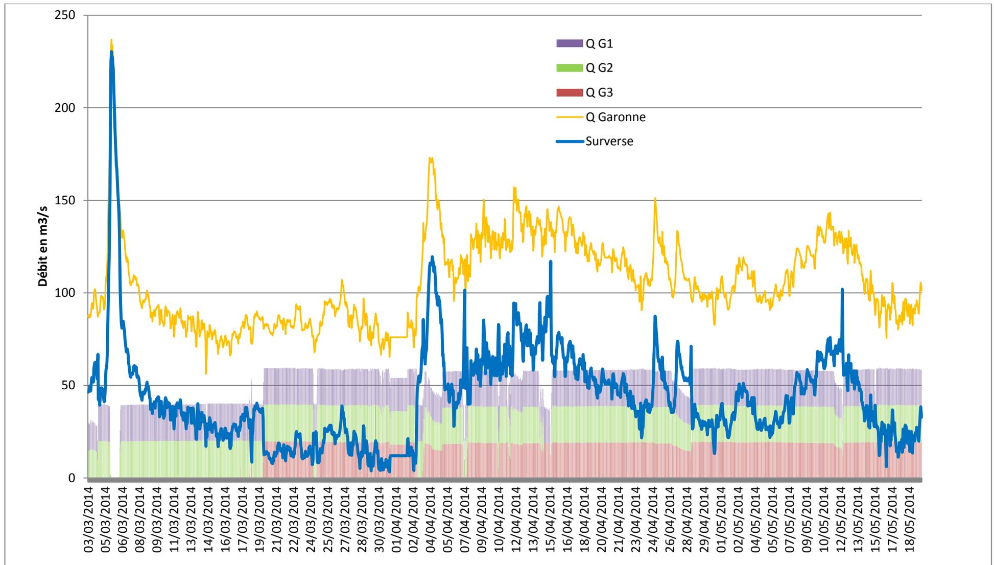
Figure 5 : Détails du fonctionnement des groupes de l'usine de Pointis durant la campagne 2014 (débit exprimée en m<sup>3</sup>.s<sup>-1</sup>)
