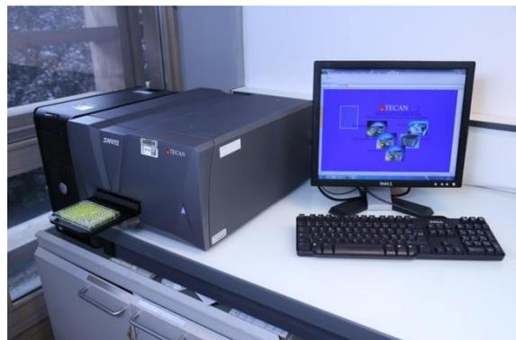
Figure 17 : Mesure des cinétiques d'absorption par spectrophotométrie
