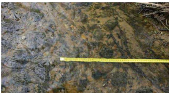
galets entre 2 et 8cm à l'aval du seuil (identiques au pont amont)
