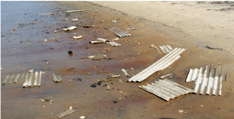
Figure 52 : La confection de mauvaise qualité pose, en outre, le problème de l'arrachage des matériaux en cas de tempête
