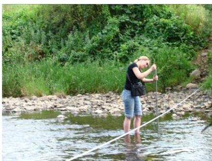
**Photo 1 : Mesure du débit de la Rhue à Condat (juillet 2008)**
