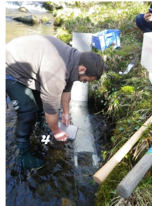
**Photo 11 : Disposition d'un incubateur de terrain Firzlaff.**
