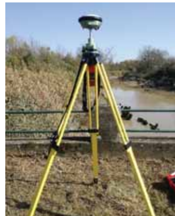
Figure 56 : Photographie du trépied du GPS différentiel
