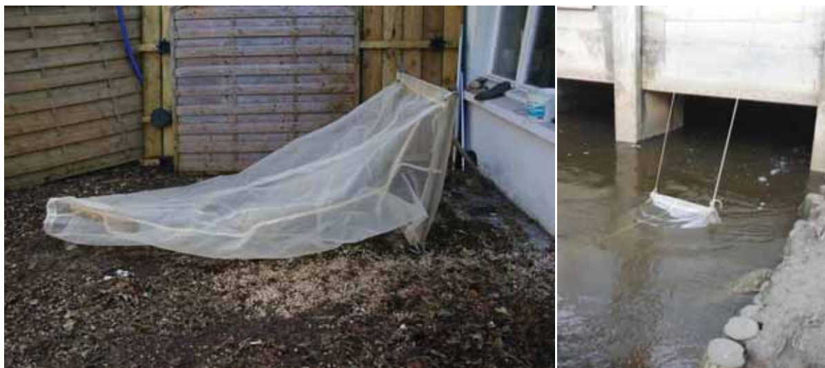
Figure 28 : Cadre de pêche utilisé pour suivre le flux entrant de civelles.
