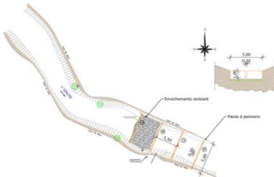
Figure 18 : Schéma du type de passe à poissons pouvant être mis en place au niveau du site de l'Oustalet
