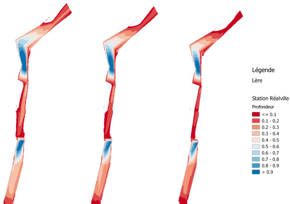
Figure 19 : Carte de variation des profondeurs (en mètres) à trois débits différents (respectivement de la gauche vers la droite : 250, 100 et 20 l/s) sur la station de Réalville
