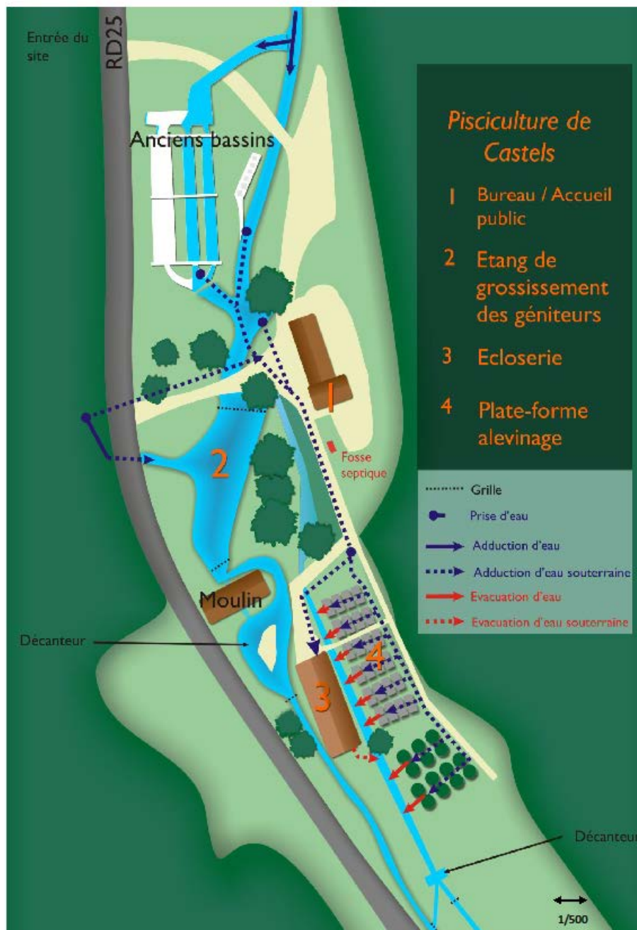
Figure 1 : Plan de la pisciculture de Castels, bâtiments et dispositif de production.
