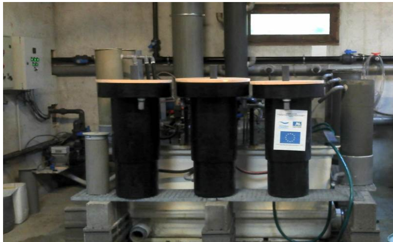
Photographie 5 : Circuit fermé principal et incubateurs à œufs verticaux.
