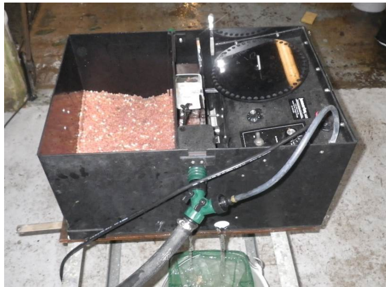
Photographie 8 : Tri automatique des œufs pour éliminer les morts.
