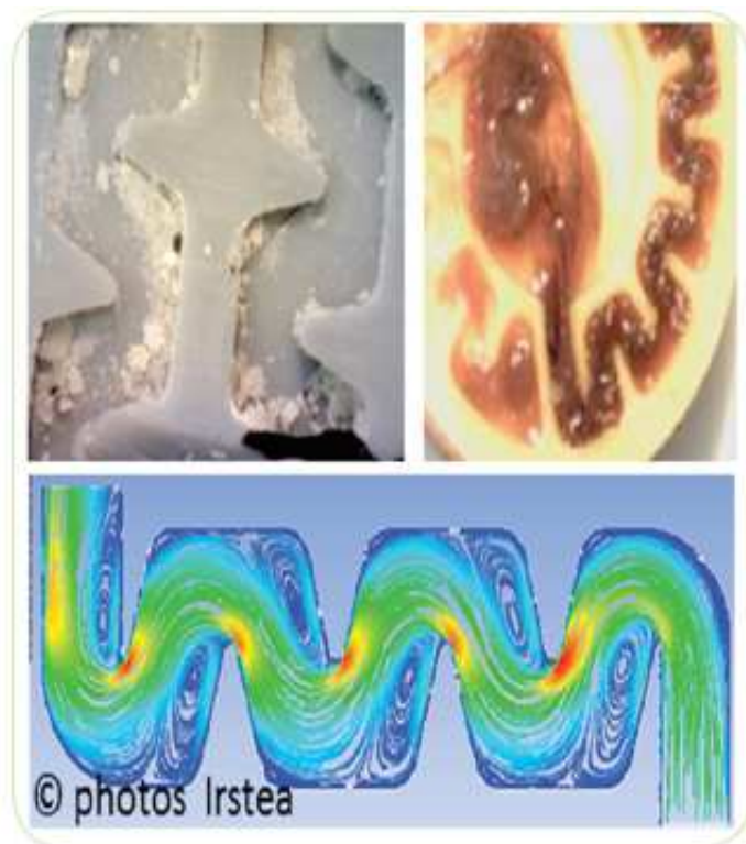
Labyrinthe d'un goutteur de micro-irrigation : colmatage et visualisation du flux
